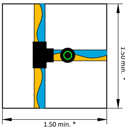
\* En cas d'obstacle (arbre, trottoir, muret, etc.), la largeur de fouille sera adaptée à la situation avec l'accord du monteur.
