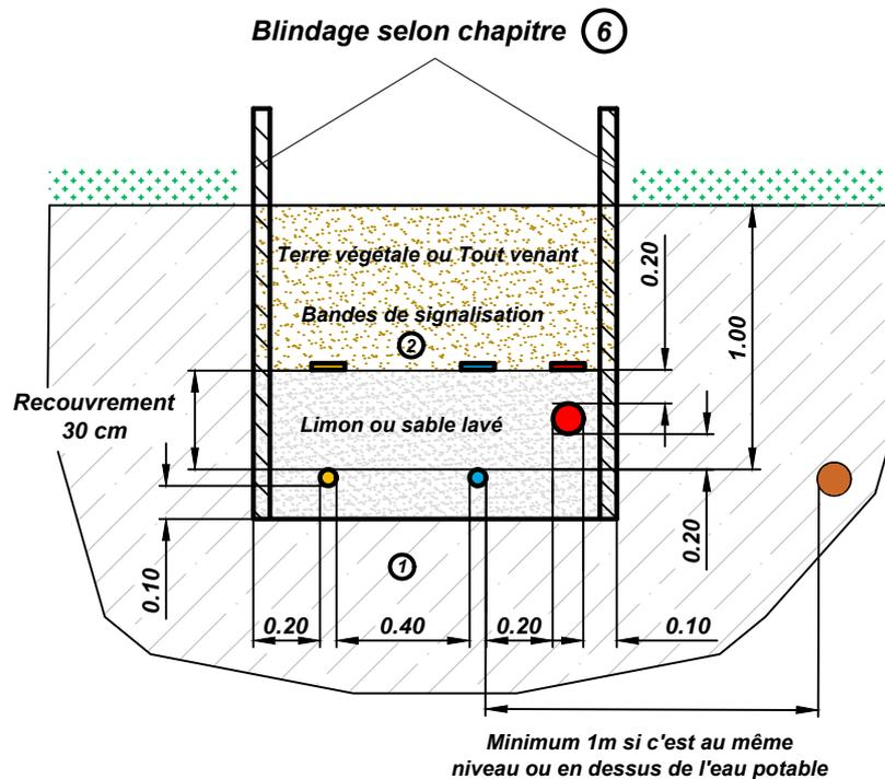
La profondeur de la fouille sera adaptée en fonction des services posés
