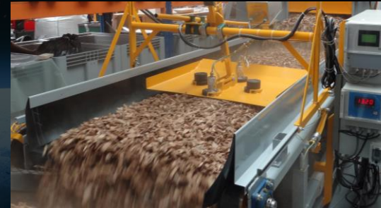
Mesure en continu de l'énergie contenue dans les plaquettes forestières
