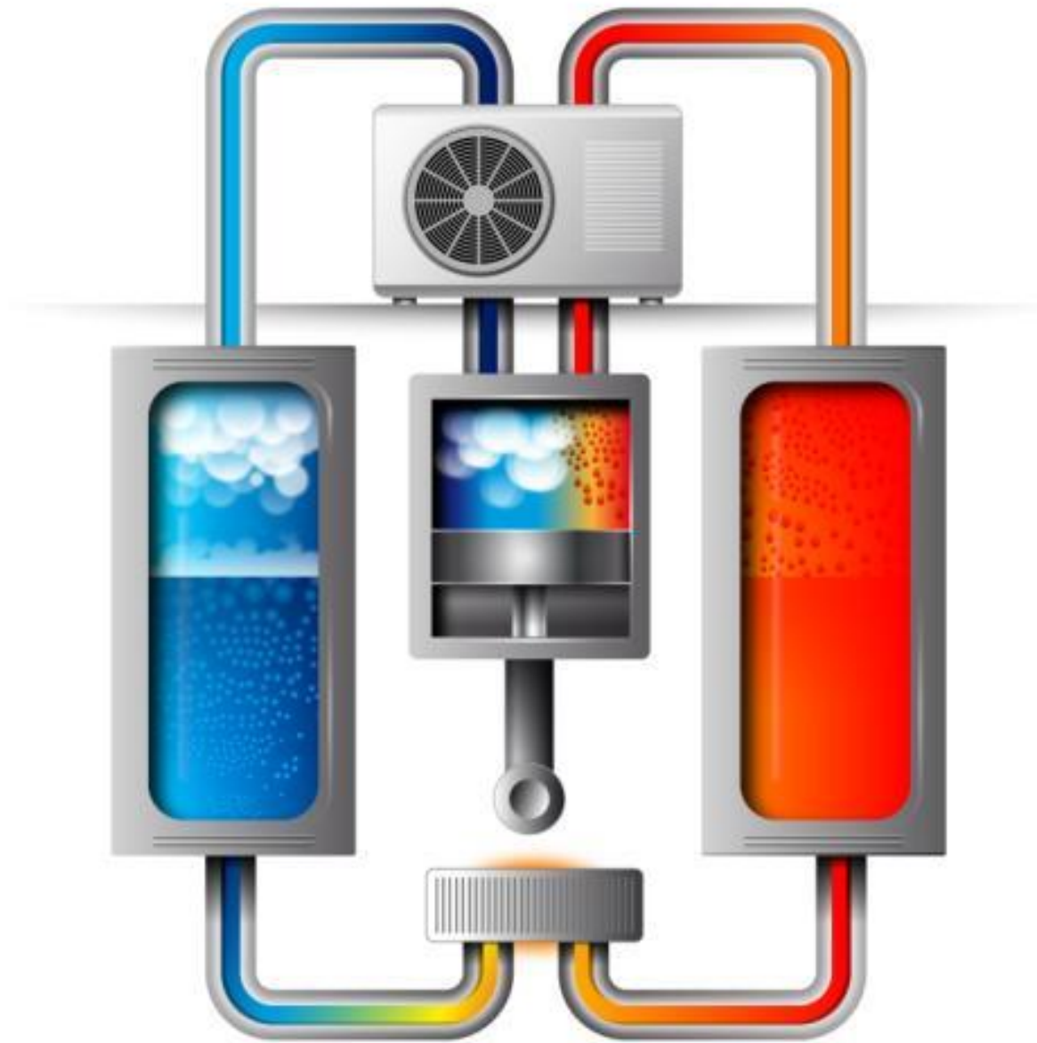
Pompe à chaleur
